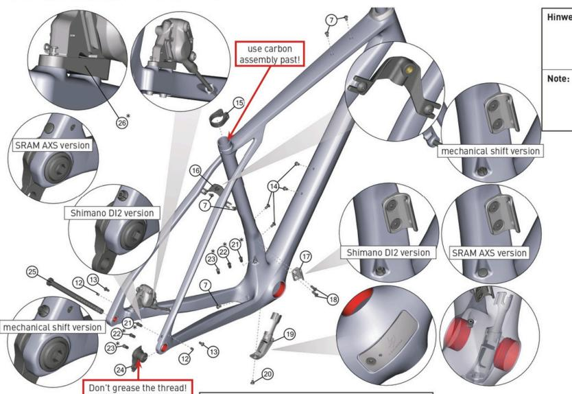
Hinweis: Bei den Schrauben muss mittelfeste Gewindesicherung verwendet werden. Rote Flächen müssen ge-
