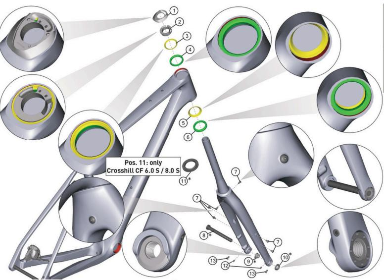
Hinweis: Bei den Schrauben muss mittelfeste Gewindesicherung verwendet werden. Rote Flächen müssen ge-
